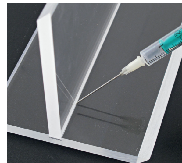
Bild 5: T-Verklebung von Polycarbonat mittels Spritze und Kanüle
